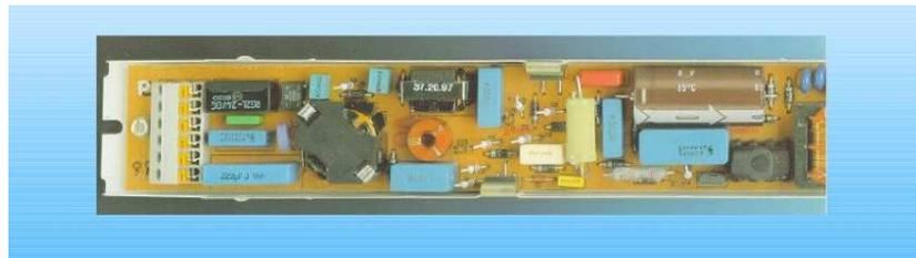
*Figura 3. Balastos electrónicos*
