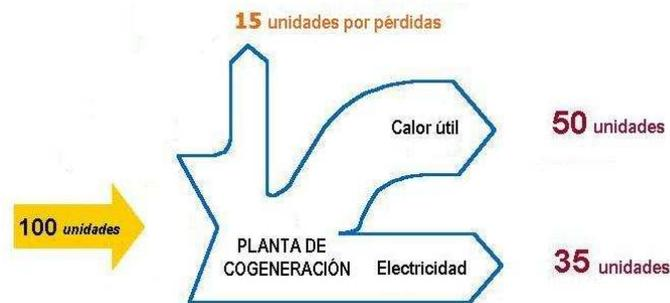
Balance aproximado de energía de una planta de cogeneración
