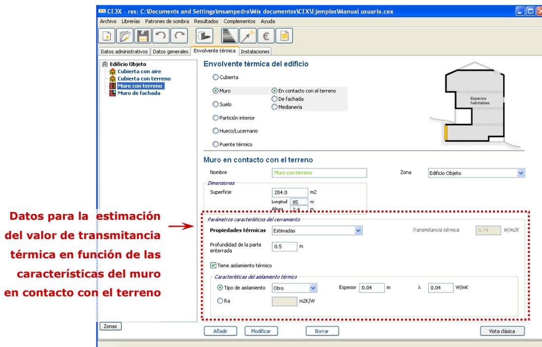
Datos para la estimación del valor de transmitancia térmica en función de las características del muro en contacto con el terreno
